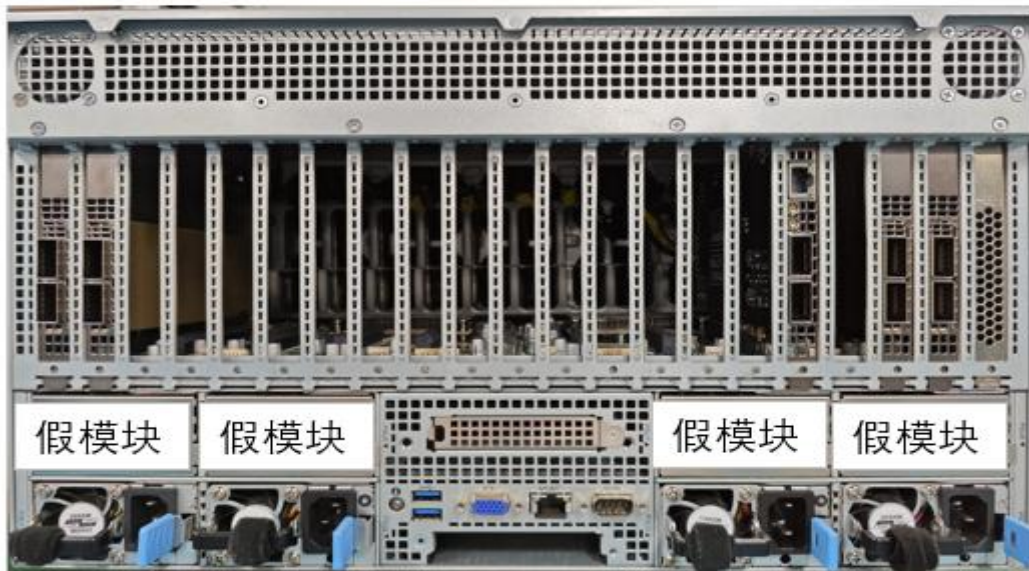
不带Busbar功能安装4电源
