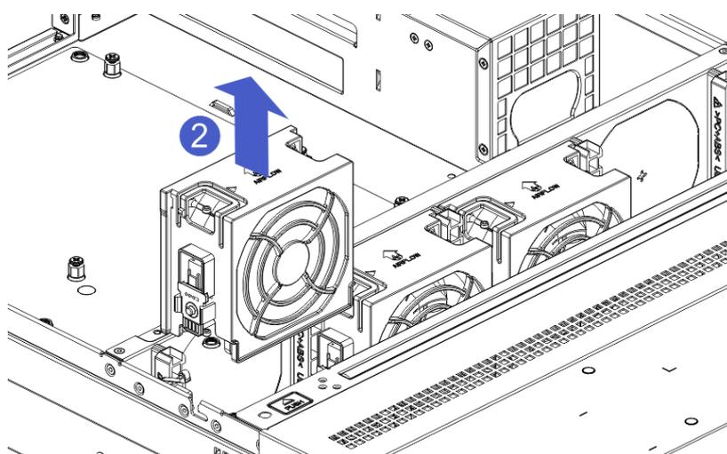
1-3.第四个风扇的支持，该机箱默认支持三个风扇，如需安装第四个风扇，需要反复要定第四个风扇位置的钣金挡片，此挡片脱落后，才能安装风扇转接板及风扇模块。
