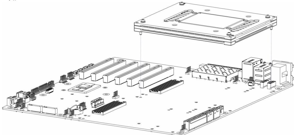
4-1.用 4 颗十字槽盘头弹平垫组合螺钉 (GB/T9074.4 M3X320) 将模组固定锁紧到主板上。
