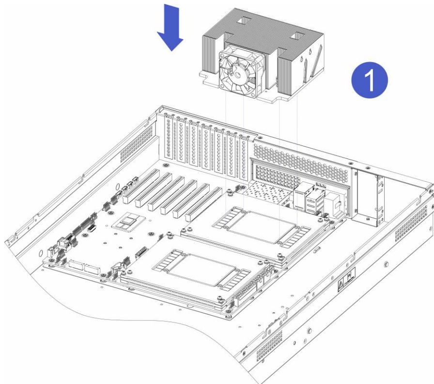
1-2.按下图所示顺序依次锁紧散热器上的 4 颗弹簧螺钉，将风扇线插入到主板对应的连接器中。
