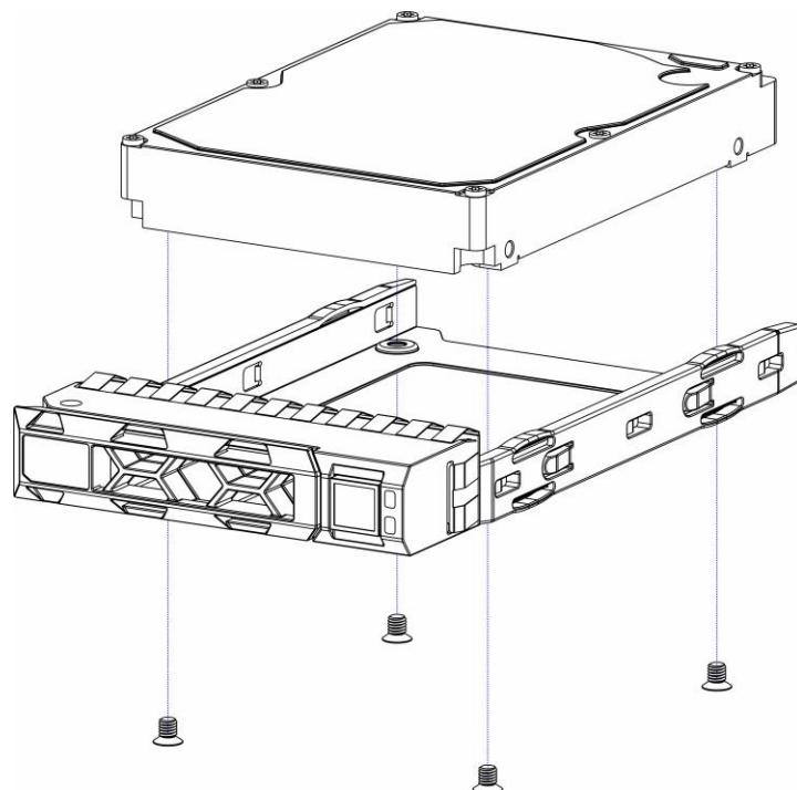
1-4.打开硬盘托架扳手，将硬盘模块缓慢插入到机箱的硬盘框中直至推不动。再旋转硬盘托架扳手直至听到“咔”
