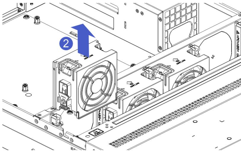
1-3.第四个风扇的支持，该机箱默认支持三个风扇，如需安装第四个风扇，需要反复定第四个风扇位置的钣金挡片，此挡片脱落后，才能安装风扇转接板及风扇模块。
