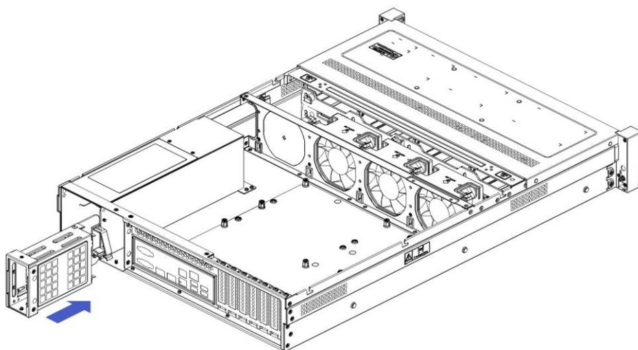
1-2. 安装好了内置 2.5HDD 组件后，将左右及上面的 5 个螺丝孔的位置附锁螺丝，主要是把内置 2.5HDD 组件与后窗及电源组件固定在一起；
