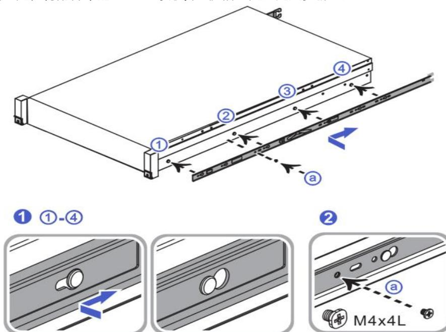
将内轨从机箱中取出时，需解锁内轨中的卡扣如图所示：
