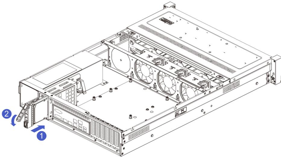
1-5.PCie 扩展卡的安装安装好的后置 2.5HDD 模块的效果图;
