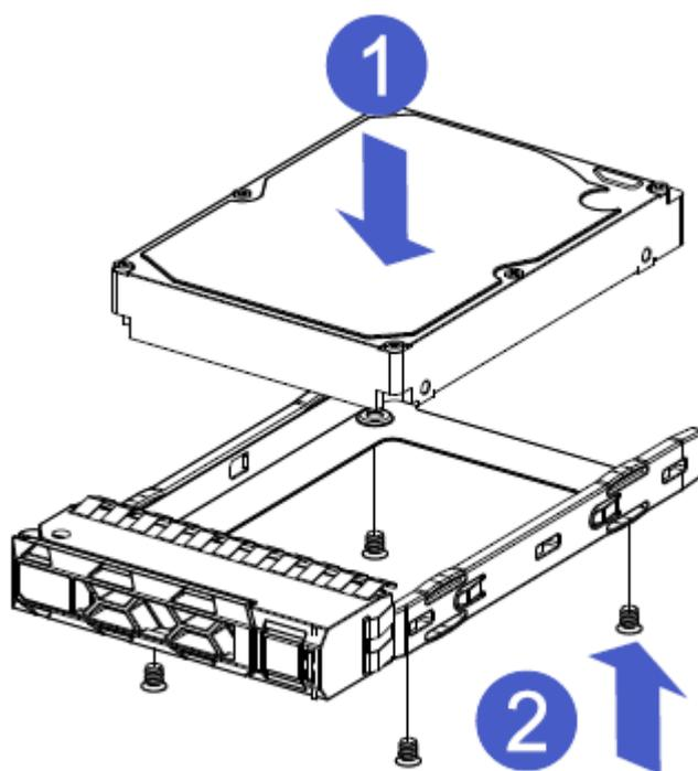
1-4.将 2.5HDD 模块插入后内置 2.5HDD 组件内,直到插入内置 2.5HDD 背板连接器内,然后再把 2.5HDD 模块按键扣上就 OK;
