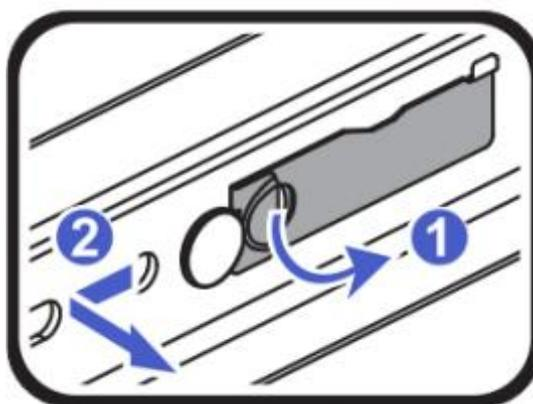
步骤 3. 安装导轨到机架内（左右导轨对称，请重复安装）
