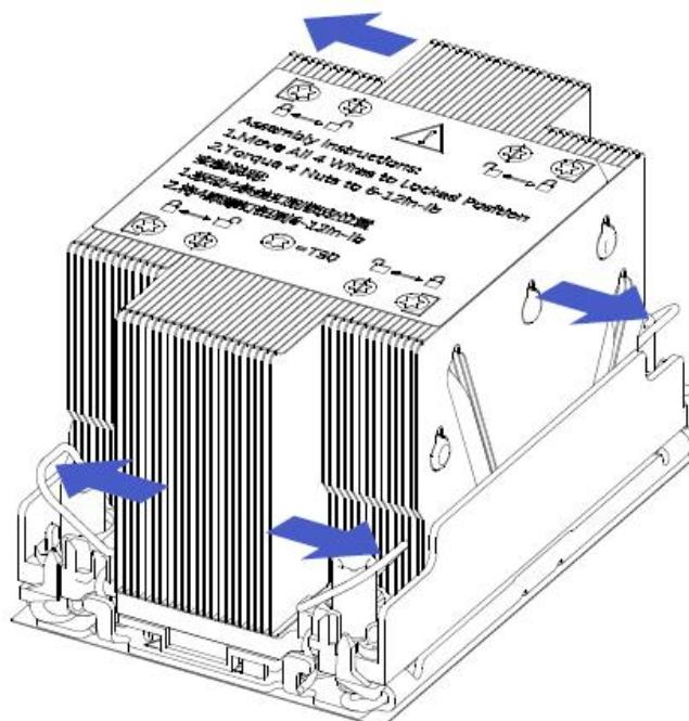
4. 使用 T30 梅花螺丝刀拧紧固定散热器的螺钉。
