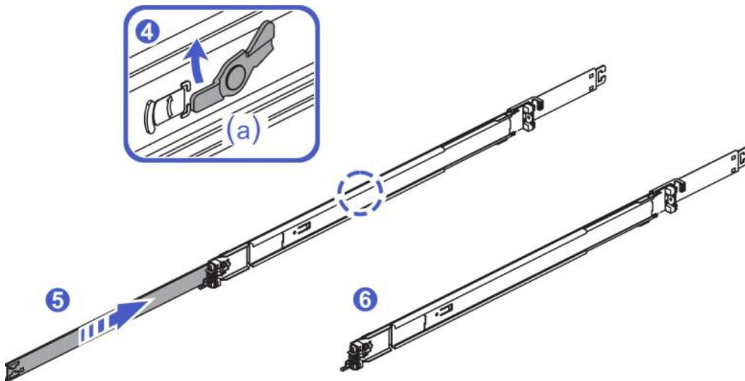
步骤 2. 安装内轨到机箱上(左右内轨安装方式一样)
