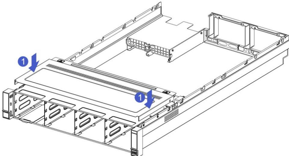
1-2. 按箭头方向推进到前上盖与机箱前端面平齐及两侧锁扣咔的一声锁止到位。
