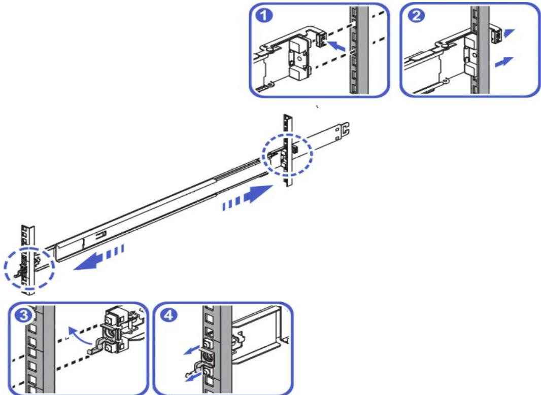
将导轨从机架中取出时，需解锁导轨中的卡扣如图所示：
