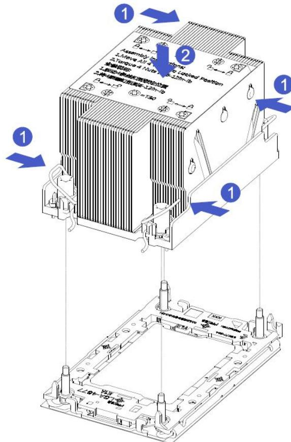
3. 按箭头方向按下散热器上的紧固锁扣，使之与处理器底座的卡钩卡住。
