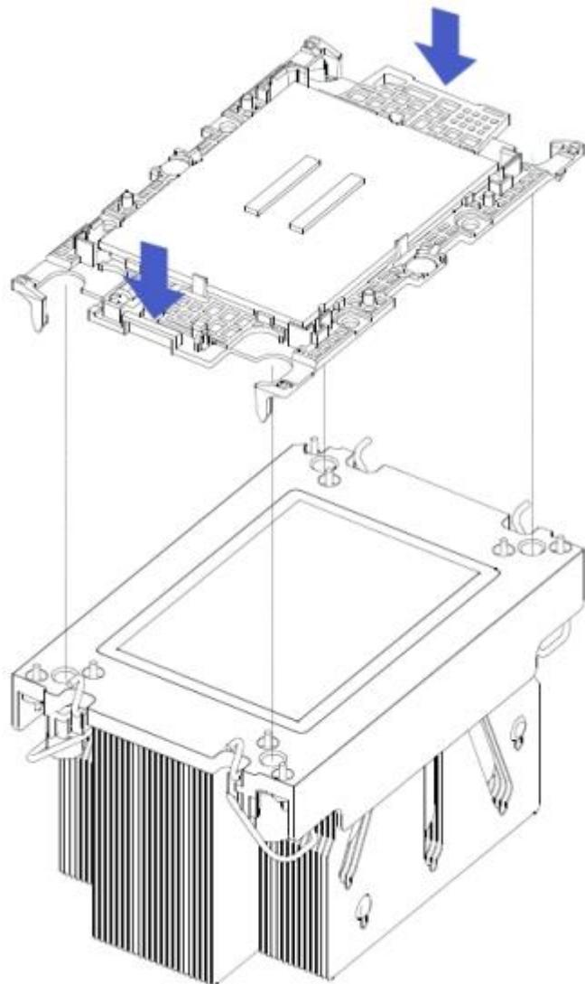
2-3. 仔细检查夹持片与散热器的安装情况，保证夹持片完全卡紧和平整。
