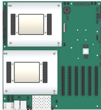
T1HDE 是同泰怡全自主开发的一款支持华为鲲鹏 920-Max/920-Smart 模组的双路 E-ATX 标准主板, 该主板 I/O 扩展丰富, 配置灵活, 可充分发挥鲲鹏模组的计算性能, 适用于云计算、边缘计算、AI 大模型推理、网络安全等应用场景。
