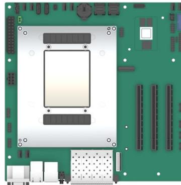
T1HSE 是同泰怡全自主开发的一款支持华为鲲鹏 920-Max/920-Smart/920-Lite 模组的单路 Micro-ATX 标准主板，该主板 I/O 扩展丰富，配置灵活，可充分发挥鲲鹏模组的计算性能，适用于边缘计算、AI 推理、网络安全、工控，以及各类定制化边缘侧应用场景。
