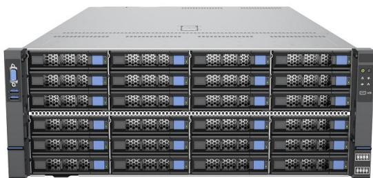
同泰怡TS357 是一款面向存储应用的全国产服务器，基于飞腾FT-2000+ 处理器芯片平台，实现了国产服务器存储性能，计算性能、 IO 扩展等方面的全面突破。存储配置可根据业务需求进行弹性配置，实现了优异的性价比和能耗比，可广泛应用政府、企业事业单位，以及行业、渠道等领域。
