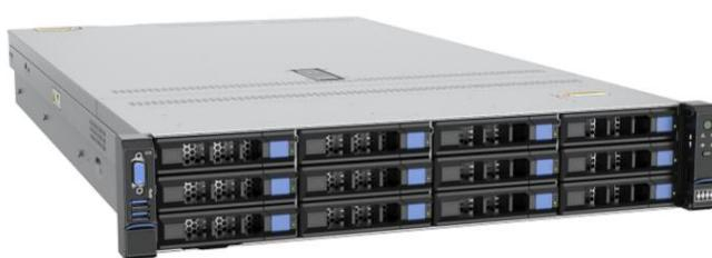
同泰怡 TU528V3 是一款具有广泛用途的 2U 双路通用服务器，基于第四代或第五代英特尔®至强®可扩展处理器，主板采用 E-ATX 标准板型设计，该产品具备卓越的计算性能和超高的性价比，适用于云计算、虚拟化、分布式存储、超融合等应用。
