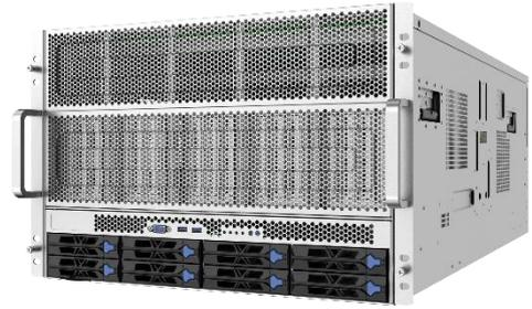
TG678V3 是一款具有广泛用途的 8 卡 GPU 服务器，支持第四代或第五代英特尔® 至强® 可扩展处理器，支持 8 张 600W GPU，具备性能卓越、扩展性强和可靠性高等特点，适用于人工智能、大模型推理、图形渲染、云游戏等多种应用场景。
