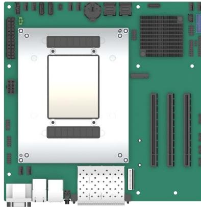
T1HSE 是同泰怡全自主开发的一款支持华为鲲鹏 920/920S/920L 模组的单路 Micro-ATX 标准主板，该主板 I/O 扩展丰富，配置灵活，可充分发挥鲲鹏模组的计算性能，适用于边缘计算、AI 推理、网络安全、工控，以及各类定制化边缘侧应用场景。
