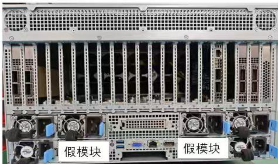
带Busbar功能安装6电源
