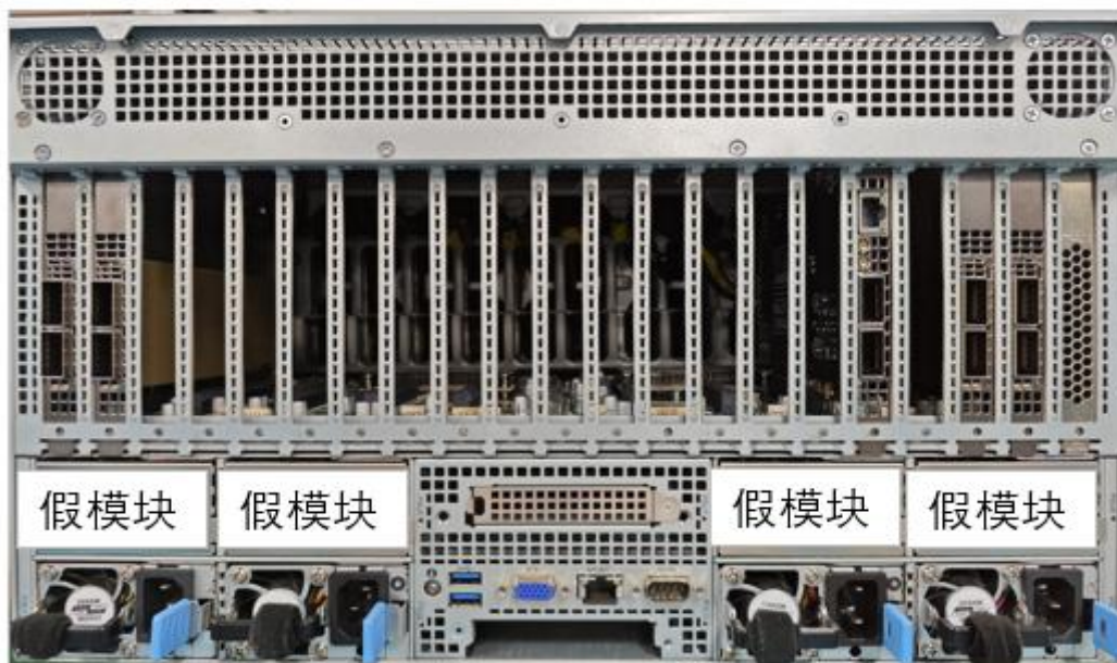
不带Busbar功能安装4电源
