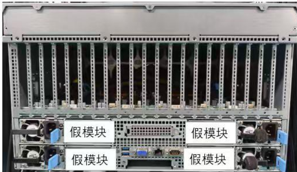
带Busbar功能安装4电源
