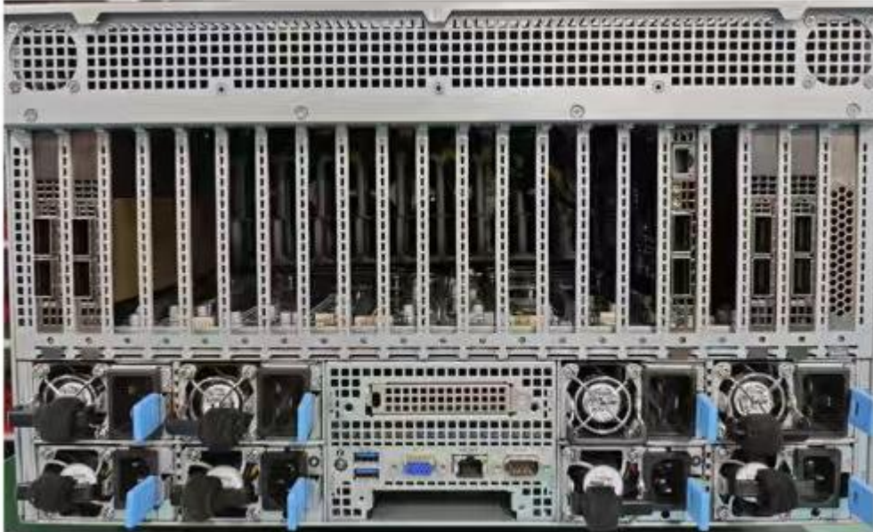
带Busbar功能安装8电源
