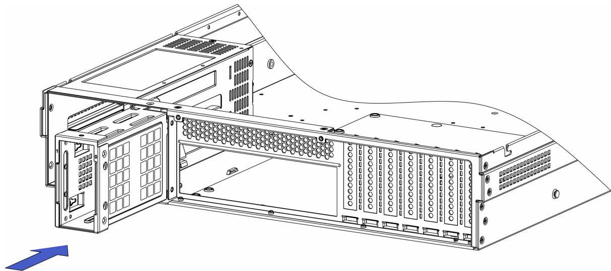
1-2. 用 5 颗#6-32X4.5 十字槽沉头螺钉 (KM-632X4.5 NYLOK) 分别从 2.5 英寸硬盘框的左右两侧和顶面将硬盘框锁紧固定, 如下图所示;
