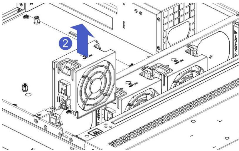
1-3.第四个风扇的支持，该机箱默认支持三个风扇，如需安装第四个风扇，需要反复定第四个风扇位
