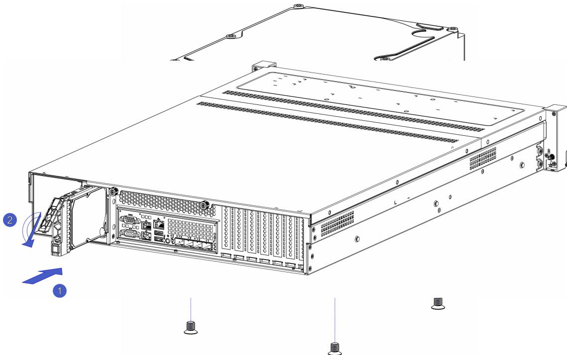
1-4. 打开硬盘托架扳手，将硬盘模块缓慢插入到机箱的硬盘框中直至推不动。再旋转硬盘托架扳手直至听到“咔”的声响使其关闭。
