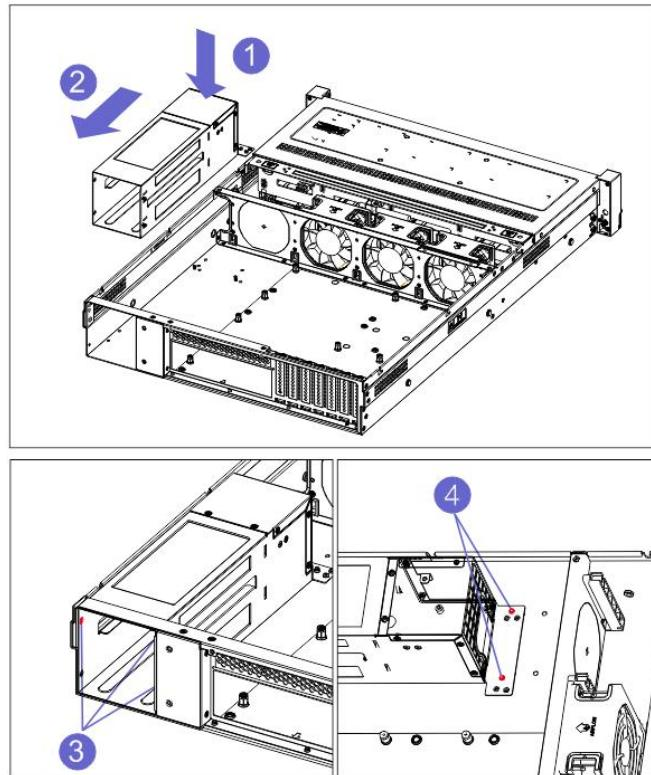
1-5.将电源模块 PSU1 和 PSU2 分别插入电源框架里；
