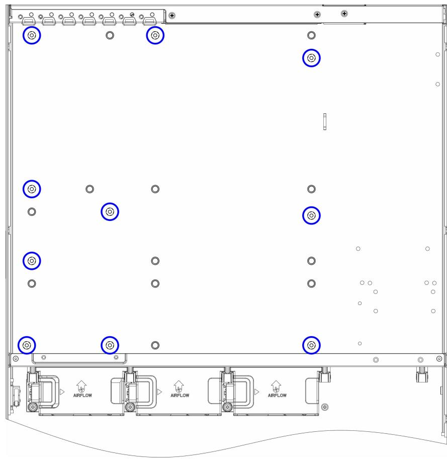
步骤 2：将主板倾斜（10~30 度）使主板 IO 区域的接口对准插入到机箱 IO 挡板上的开孔中，再缓慢将主板放下。
