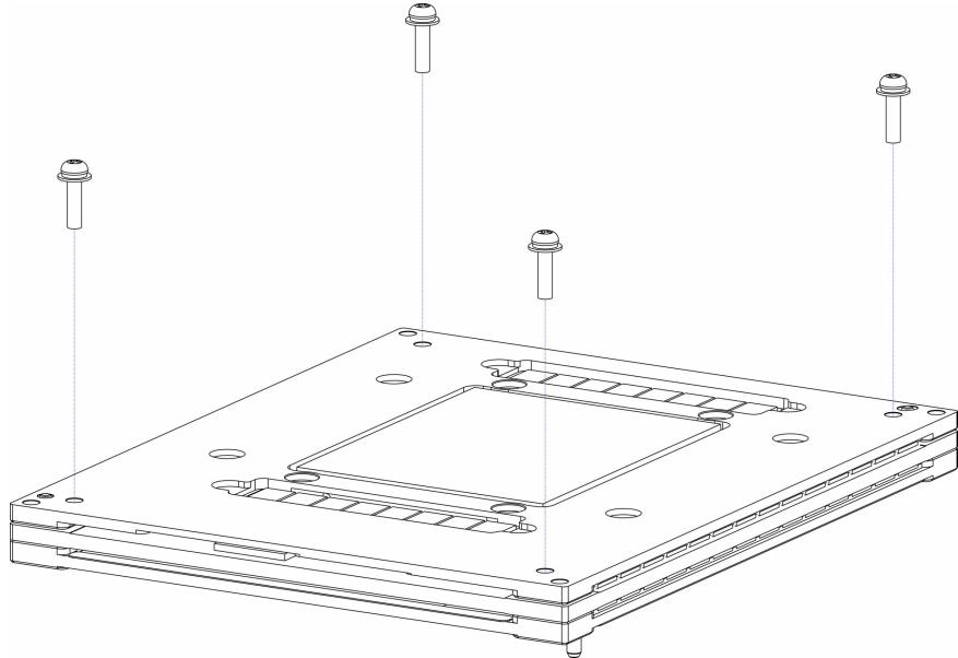
3-1.将前面步骤安装好的模组调整好位置，使 2 个导向销钉和连接器与主板上的 2 个定位孔和连接器对准，将模组缓慢按压插入到主板上，注意检查连接器位置确保扣合到位，可在连接器位置处多按压 2 次。
