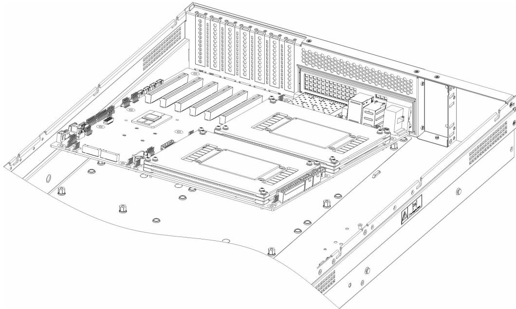
步骤 3：用附件盒中的主板固定螺钉将主板锁紧固定。
