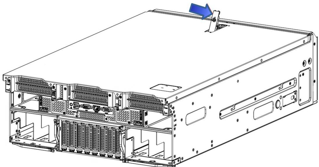
4. 使用螺丝刀将计算模块上盖扳手上的螺丝旋转至锁定位置锁定上盖；
