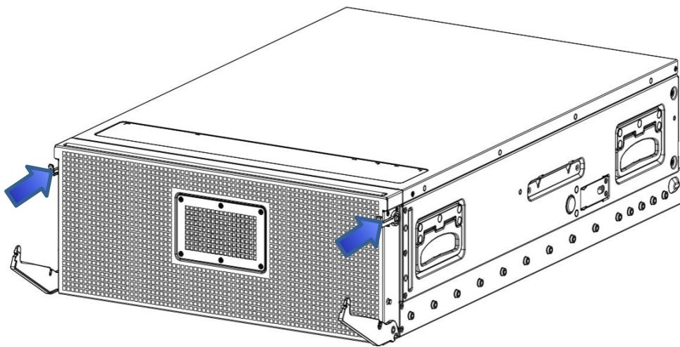
2. 由 2 人搬抬将 GPU 模块插入到机箱并缓慢推入，直至无法推动，再向内同时缓慢旋转 GPU 模块底部两侧的扳手，将 GPU 模块两侧的扳手完全旋转到位，直至听到“咔哒”声，按钮将两侧扳手完全锁住，GPU 模块安装到机箱；
