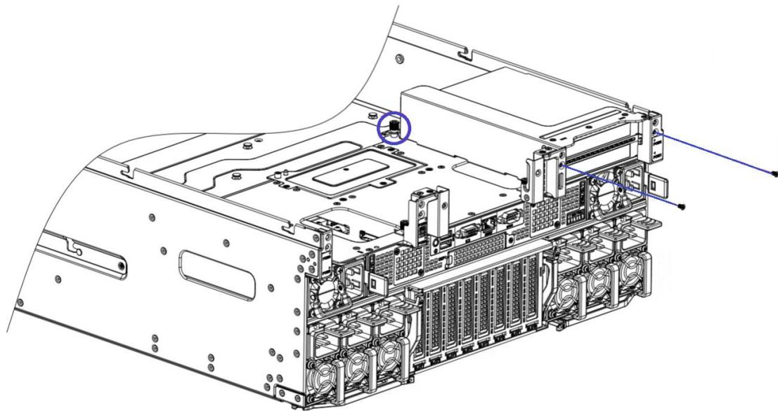
步骤 8. 将 PCIe 扩展模块线缆插入到主板中连接好，PCIe 扩展模块安装完毕；
