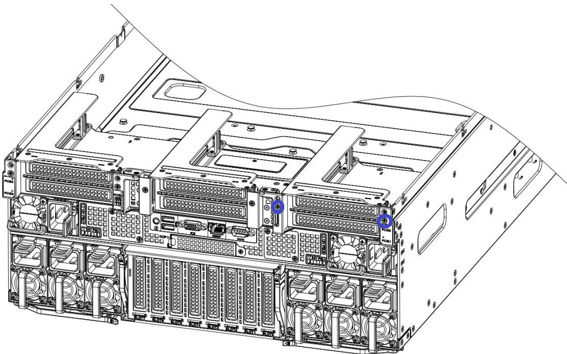
步骤 2. 用螺丝刀将 PCIe 扩展模块尾部松不脱螺钉拧松;
