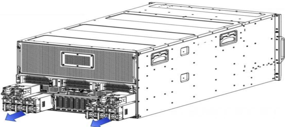
2. 按压计算模块底部两侧的拨钮，使扳手自动弹开；
