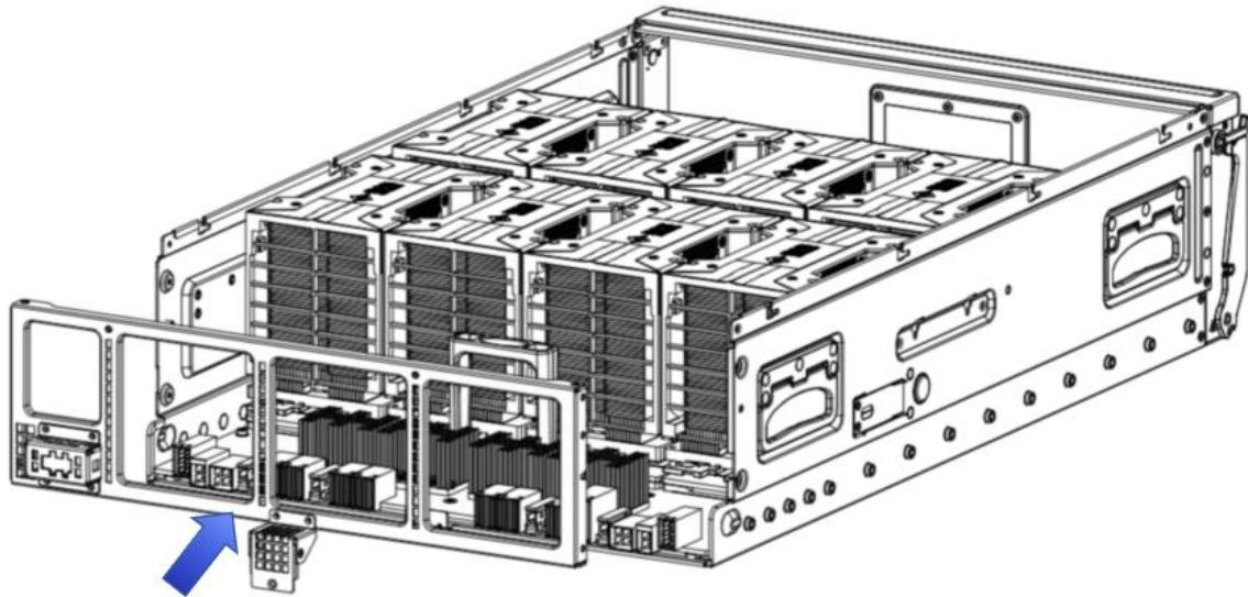
4. 锁上 UBB 板上的所有的螺丝，将 UBB 模块的后面板安装到 UBB 插框的对应位置；
