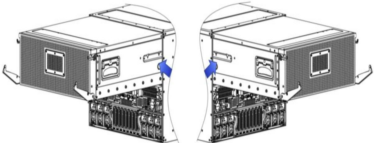
6. 将 GPU 模块两侧的扳手关闭，由 2 人搬抬放置在静电桌上；
