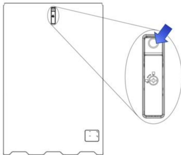
2. 将计算模块上盖水平向下放置，使计算模块上盖扳手上的孔对准机箱中的定位柱；
