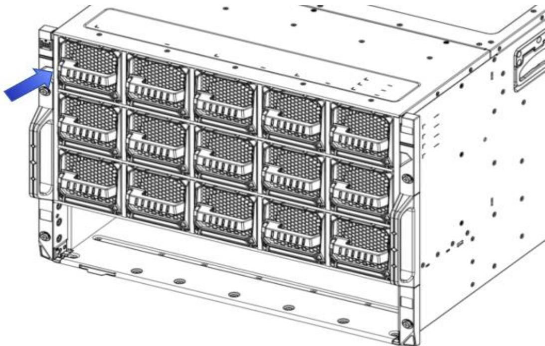
步骤 2. 适当用力将风扇从风扇仓中水平拔出；
