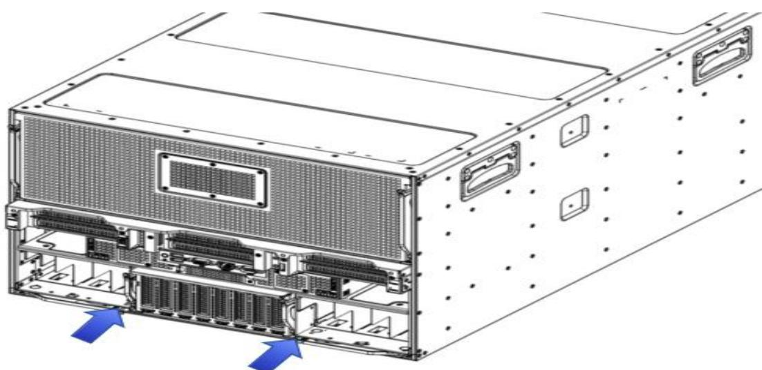
3. 向外同时转动两侧的扳手，使计算模块向外滑动；
