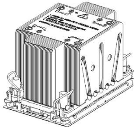
3. 按下散热器上的紧固锁扣，使之与处理器底座的卡钩卡住。
