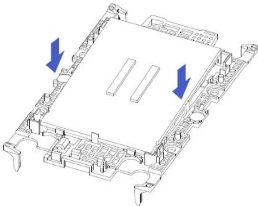
1-2. 沿箭头方向，弯曲压夹持片另一端，将 CPU 固定到夹持片上。
