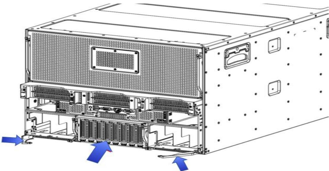
4. 将电源模块插入到机箱对应的电源仓。
