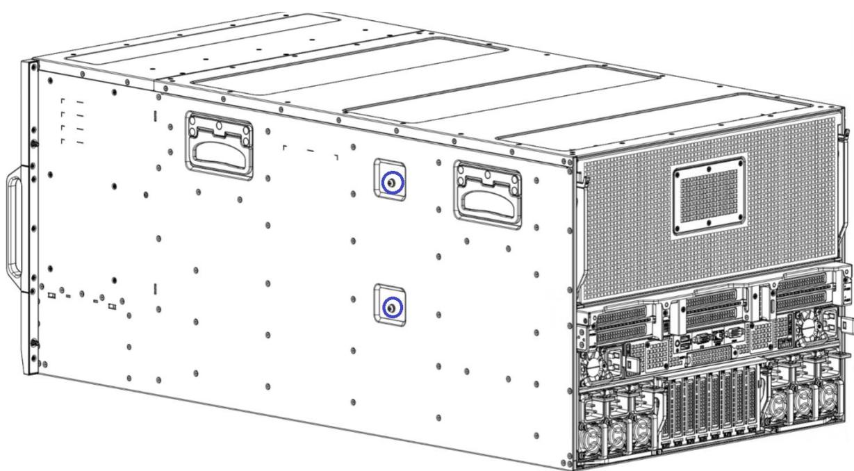
步骤3. 将机箱用升降车或者人工手动升至支架滑轨相同高度,将服务器缓慢滑入滑轨 (安装示意图如下),
