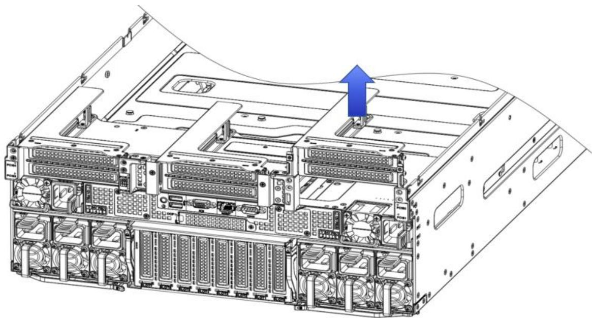
步骤 4. 用螺丝刀将锁 PCIe 挡片的螺钉拆下(螺钉保留以便后续安装 PCIe 扩展卡使用)再将 PCIe 挡片从模块中取出;
