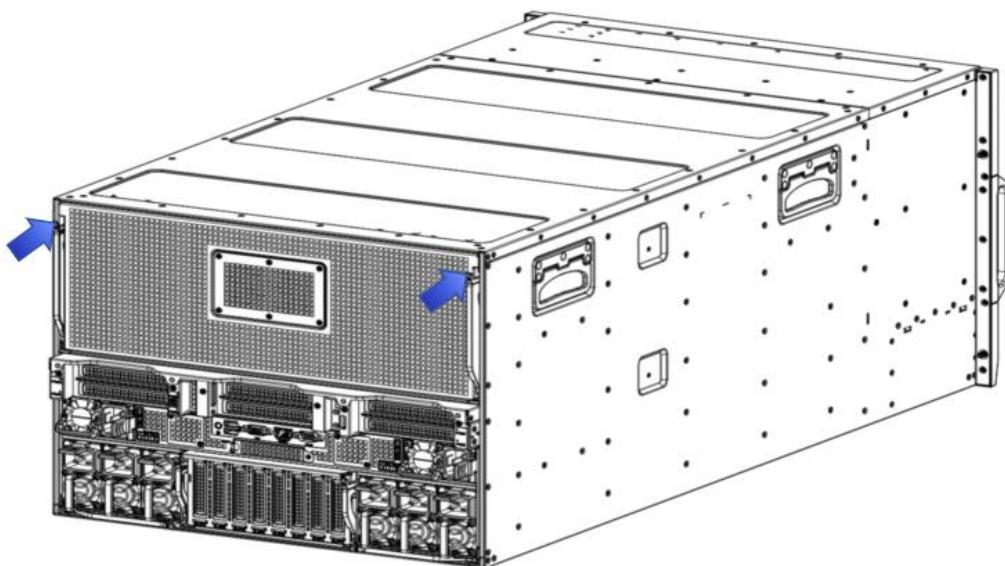
5. 当 UBB 模块到达限位处无法向外抽动时，2 人托住 GPU 模块底部，同时按压 GPU 模块两侧的限位弹片并向外缓慢抽出 GPU 模块；
