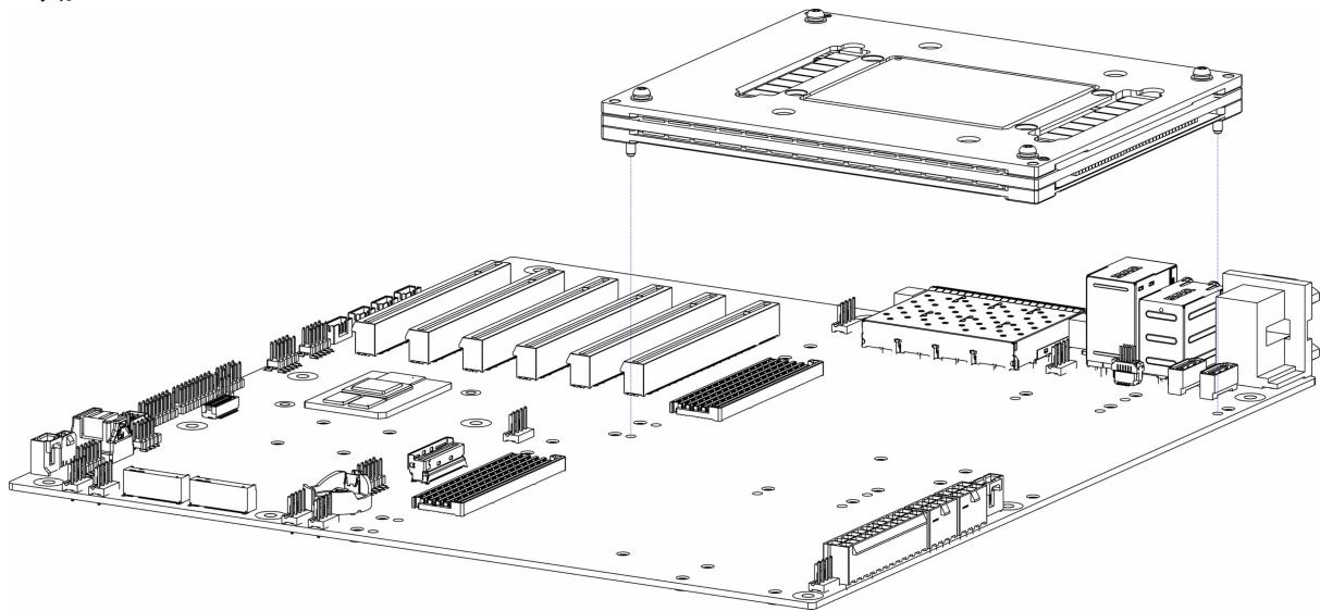
4-1.用 4 颗十字槽盘头弹平垫组合螺钉 (GB/T9074.4 M3X320) 将模组固定锁紧到主板上。
