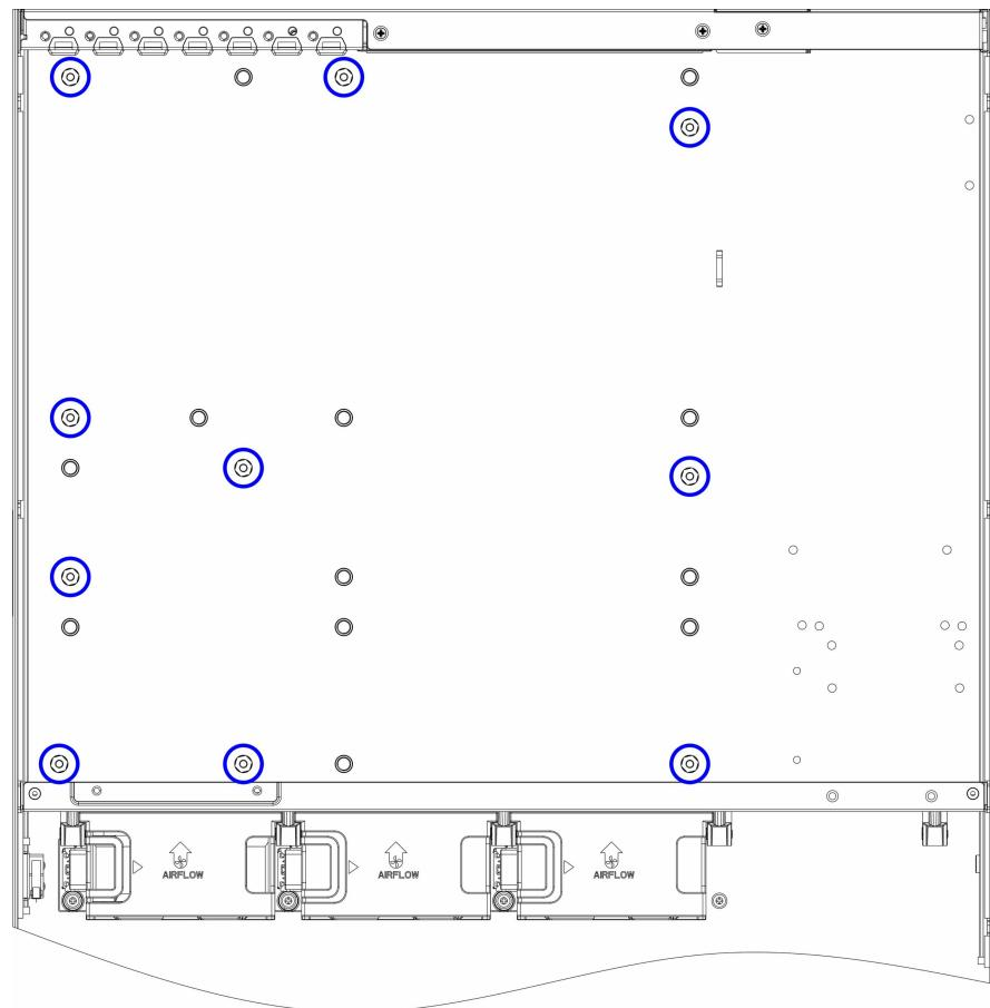
步骤 2：将主板倾斜（10~30 度）使主板 IO 区域的接口对准插入到机箱 IO 挡板上的开孔中，再缓慢将主板放下。
