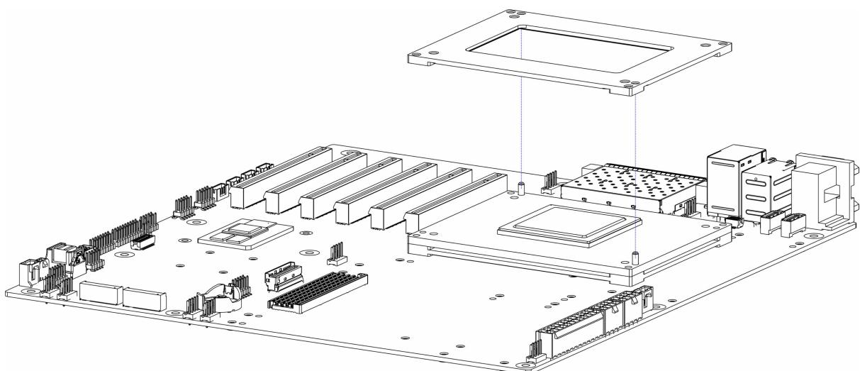
4-1.用 4 颗十字槽盘头弹平垫组合螺钉 (GB/T9074.4 M3X320) 将 KP920S 模组上支架组件固定锁紧。
