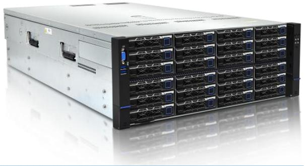
同泰怡 TS657V2 是一款 4U 双路存储服务器，基于最新一代飞腾 S5000C-64C ARM 处理器构建，具备海量存储空间、卓越的计算性能和丰富的扩展能力，实现了优异的性能比和能耗比，并可根据业务需求进行弹性配置，可广泛应用于大数据、云存储、分布式存储、温存储、冷存储等应用。
