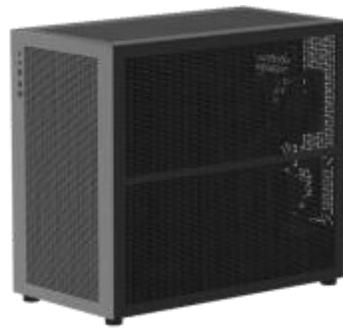
TW556V1-Q 是同泰怡自研的一款塔式 AI 一体机产品，支持两颗鲲鹏 920-Smart 模组，支持 4 个双宽全尺寸 GPU 卡，超强 AI 算力基于优异的风道散热设计，此产品可运行在办公环境，支持各类推理卡及训练卡，尤其适合 AI 推理、模型微调、本地知识库搭建、HPC、仿真渲染等应用场景。
