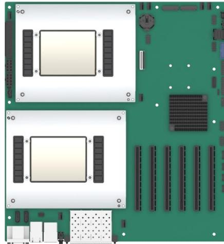
T1HDE 是同泰怡全自主开发的一款支持华为鲲鹏 920/920S 模组的双路 E-ATX 标准主板，该主板 I/O 扩展丰富，配置灵活，可充分发挥鲲鹏模组的计算性能，适用于云计算、边缘计算、AI 大模型推理、网络安全等应用场景。
