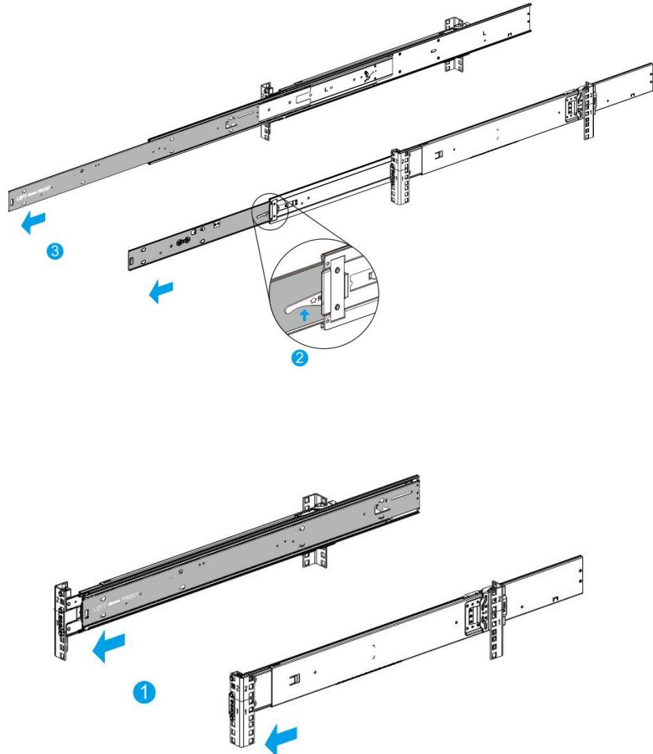
步骤 3. 安装内轨到机箱上(左右内轨一样, 请重复安装)
