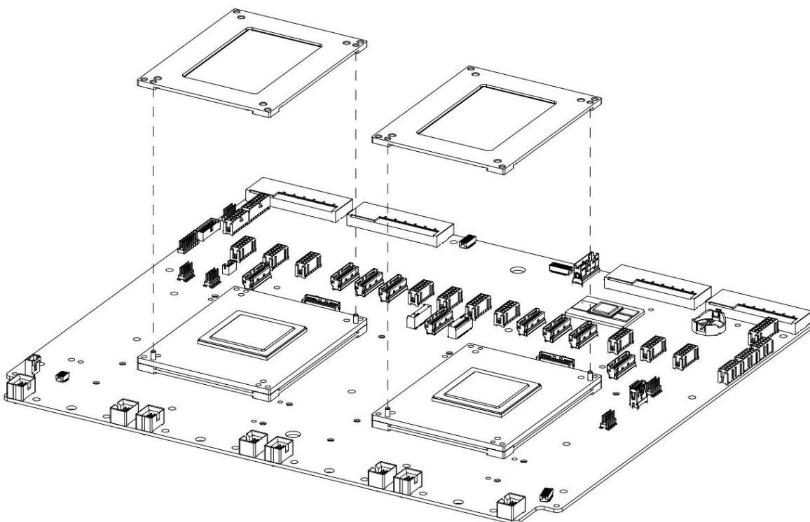
步骤 6. 用 8 颗十字槽盘头弹平垫组合螺钉(GB/T9074.4 M3X20)将 KP920S 模组上支架组件固定锁紧。
