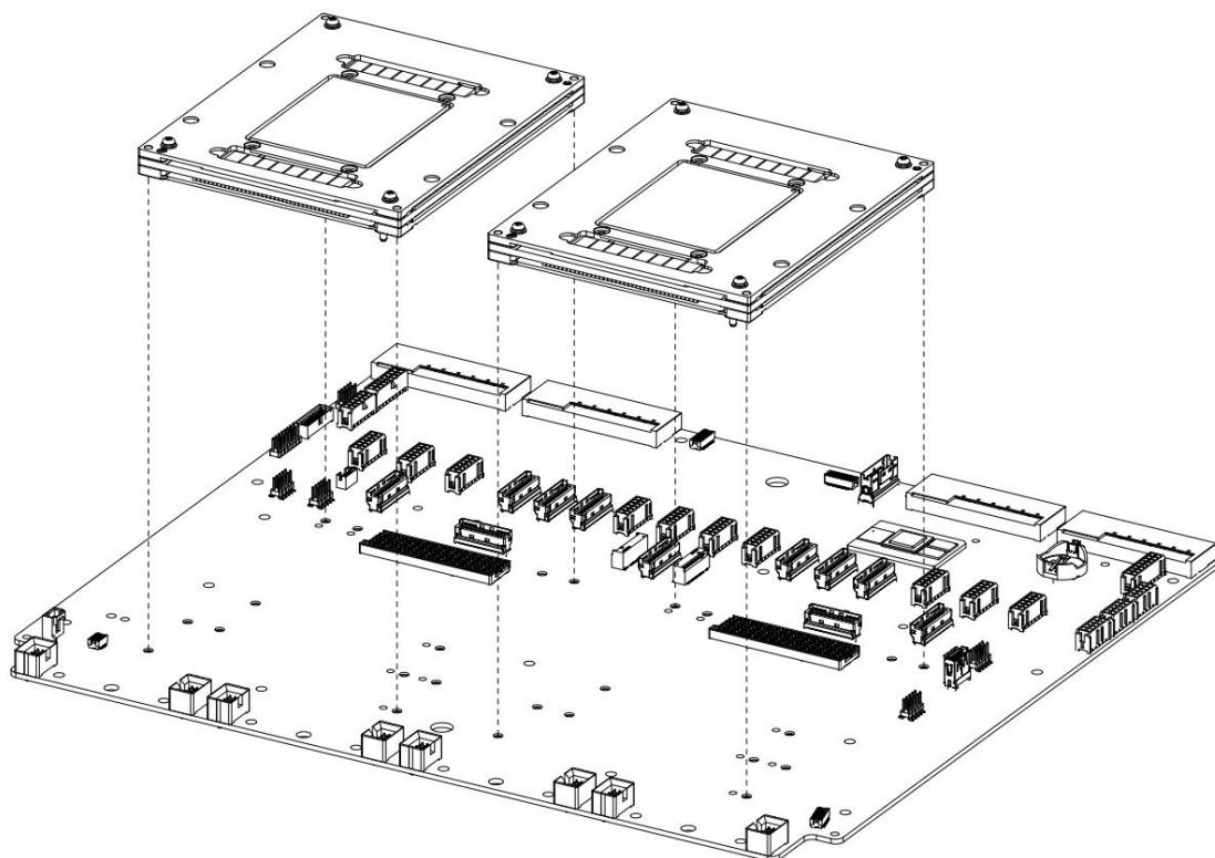
4-1. 用 8 颗十字槽盘头弹平垫组合螺钉 (GB/T9074.4 M3X20) 将模组固定锁紧到主板上。
