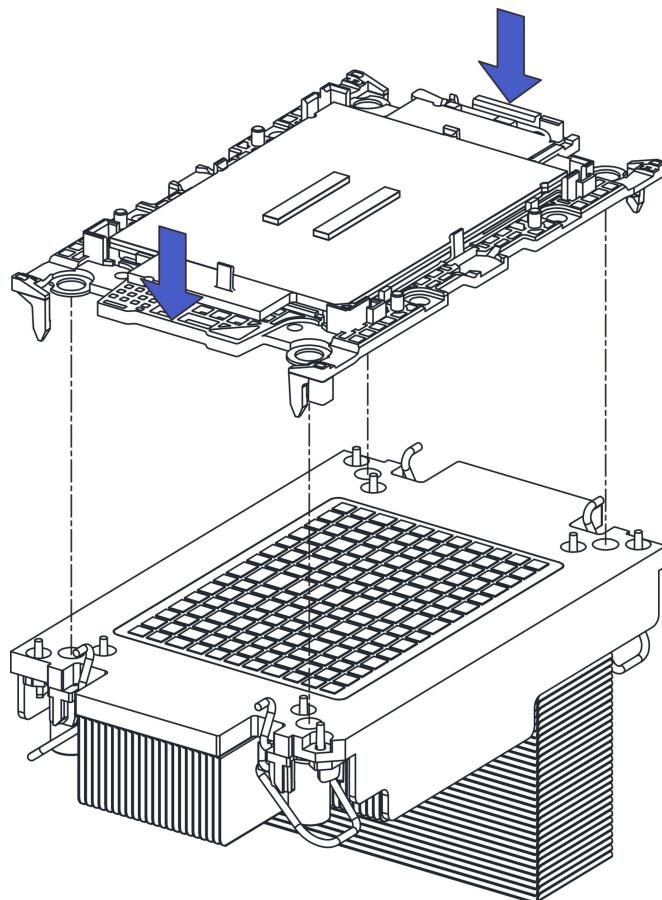
2-3. 仔细检查夹持片与散热器的安装情况，保证夹持片完全卡紧和平整。
